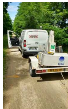
Source sismique (chute de poids accélérée) montée sur pickup (©BRGM)
